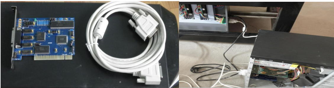
PCI 卡的安装，安装位置如下图所示
